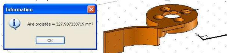
**Remarque :** le résultat que donne TopSolid correspond à la surface comprise entre le contour extérieur et les trous. Le calcul tient compte du retrait. Cette fonction est bien pratique pour les pièces qui possèdent des surfaces évolutives (le plan de joint ne correspond pas à une seule surface).
